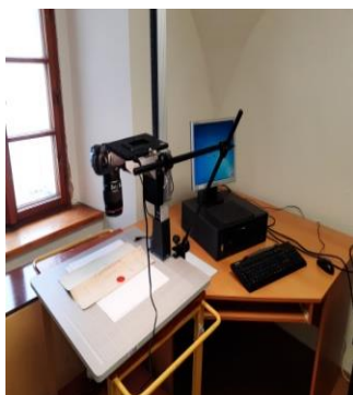
Technické vybavenie na digitalizáciu pečatí a pečatidiel
